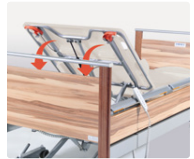
Notabsenkung der Rückenlehne, durch Zylinderfeder abgefedert
